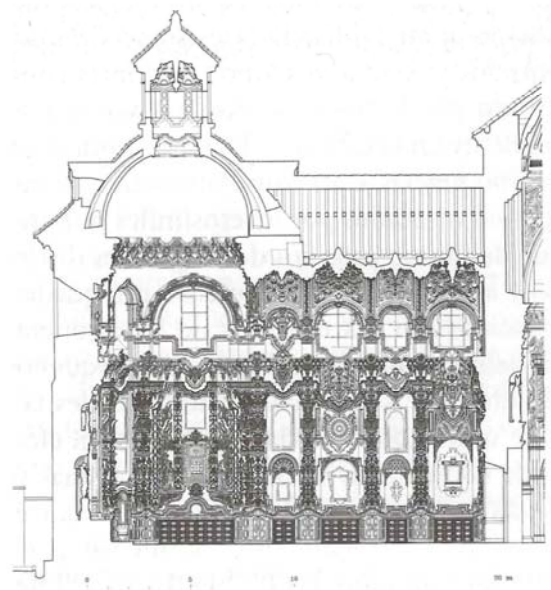
Figura 1.25. Cartuja de Granada, cúpula tabicada en la sacristía. A la izquierda, fotografía del trasdós con las lengüetas que unen cúpula y muros laterales. A la derecha, sección, en la que se aprecia que la cúpula es de doble hoja (Almagro 2012, 53)
